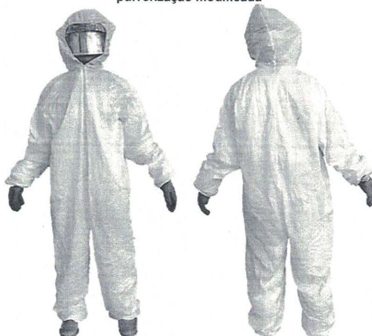
Figura 4 - CP2 - Vestimenta absorvente depois do ensaio de pulverização de líquido e ensaio de pulverização modificada
