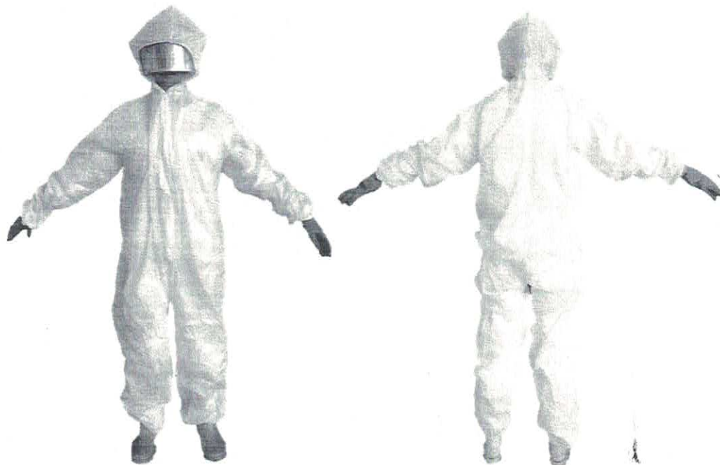
Figura 3 - CP1 - Vestimenta absorvente depois do ensaio de pulverização de líquido e ensaio de pulverização modificada
