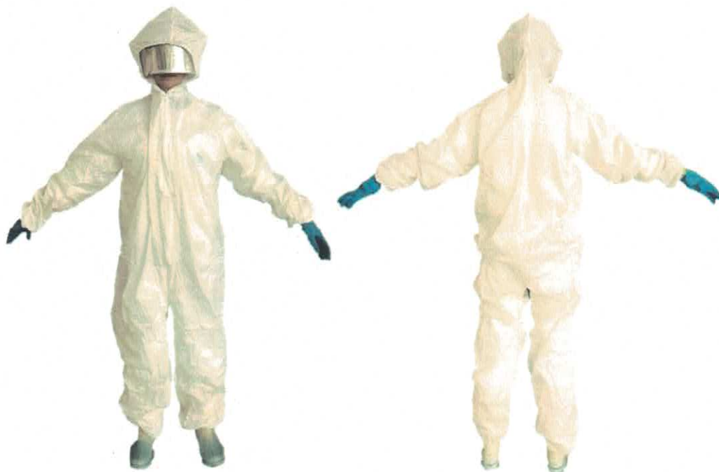
Figura 3 - CP1 - Vestimenta absorvente depois do ensaio de pulverização de líquido e ensaio de pulverização modificada
